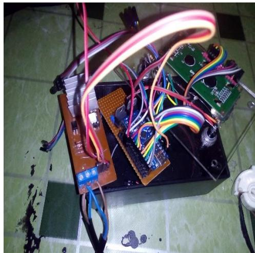
**Gambar 4.** Pemasangan semua kabel komponen ke arduino
