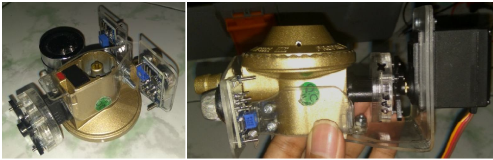
Gambar 10. udukan sensor flame , sensor gas dan motor servo
