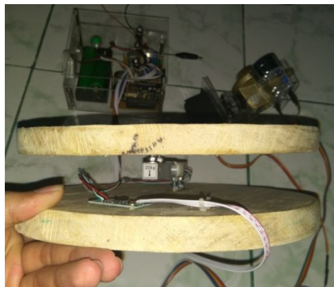
Gambar 11. dudukan load cell
