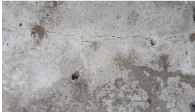
Gambar 2 B-1 Beton bakteri bacillus subtilis sebesar 0,5% pada perendaman PH 2 selama 14 hari.
