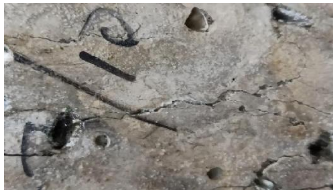
Gambar 6 C-2 Beton bakteri bacillus subtilis sebesar 1% pada perendaman PH 5 selama 14 hari.
