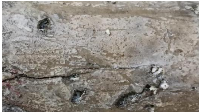
Gambar 5 C-1 Beton bakteri bacillus subtilis sebesar 1% pada perendaman PH 2 selama 14 hari.
