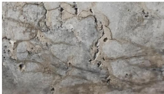
Gambar 4 B-3 Beton bakteri bacillus subtilis sebesar 0,5% pada perendaman PH 7 selama 14 hari.
