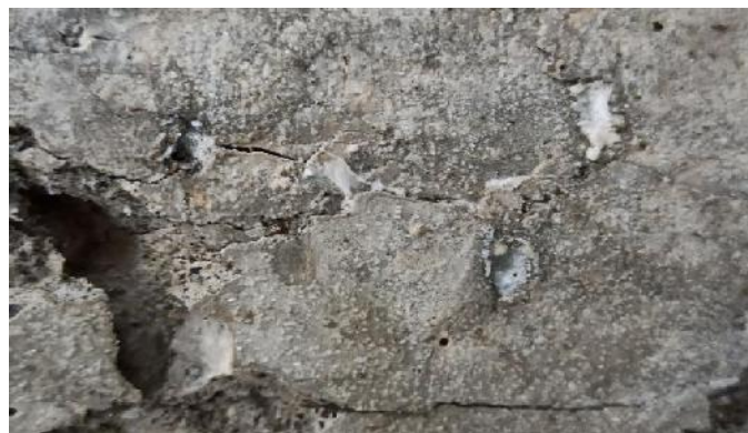
Gambar 3 B-2 Beton bakteri bacillus subtilis sebesar 0,5% pada perendaman PH 5 selama 14 hari.
