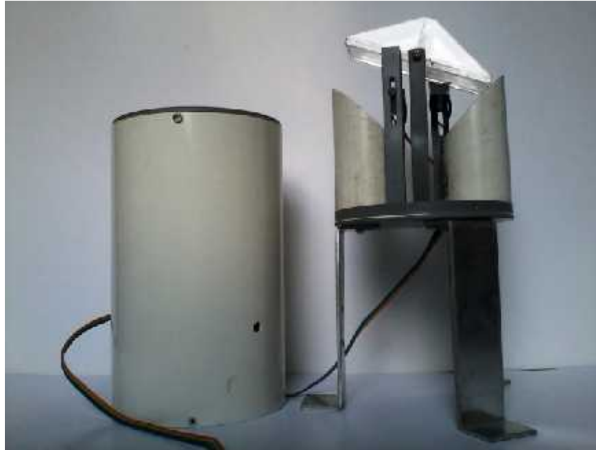
Gambar 4.3 Alat pengukur curah hujan tipe TB
