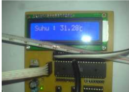
Gambar 4.6 Hasil Pengujian sensor suhu LM35
