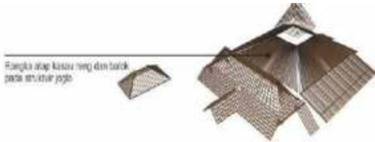
Gambar 3.27. Eksplodometri atap bangunan Masjid Pathok Negero Mlangi. Hasil olahn proses aplikasi VR (Analisis Penelitian)
