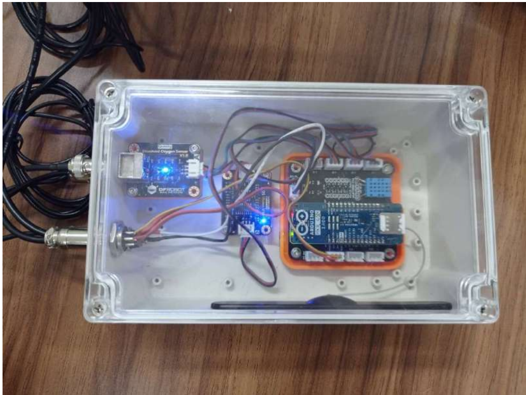
Gambar 4. Sistem elektronik terpadu untuk akuisisi data kualitas air
