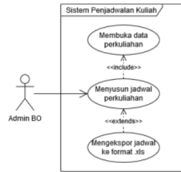
Gambar 3. Use Case Diagram dari sistem penjadwalan kuliah yang dibangun
