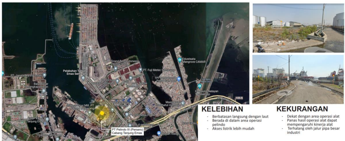
Gambar 9. Alternatif Peletakan Alat Alat Sistem Monitoring Hidrometeorologi di PT Pelindo III (Persero) Cabang Tanjung Emas.
