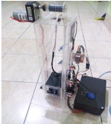
Gambar 3 : hasil rancang bangun Elevator berbasis Arduino
