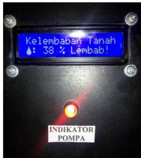
Gambar 11 Tampilan LCD Pada Sistem Penerima
