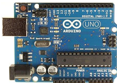
Gambar 2.3 Arduino Uno (Sumber: Hari Santoso, 2015)
