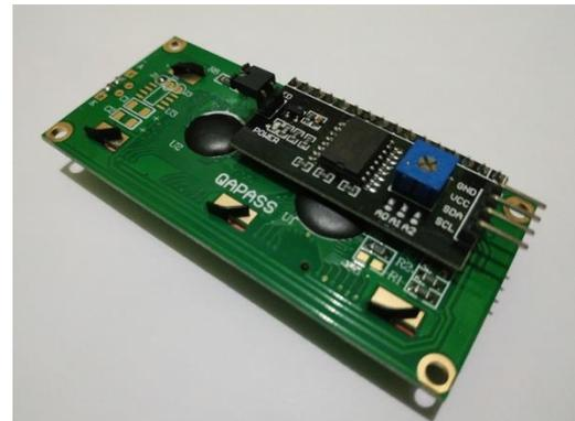
Gambar 5: Tampak Belakang Bentuk Fisik LCD I2C 16x2
