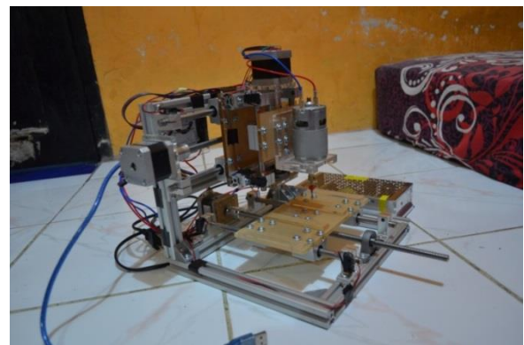
Gambar 10: Prototype CNC secara keseluruhan
