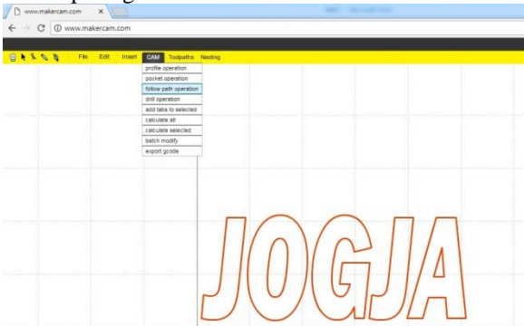
Gambar 12: Hasil open SVG file pada http://makercam.com
