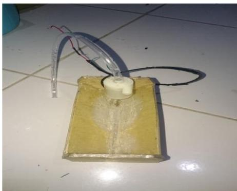
Gambar 9 :Wadah Tempat Jamur dan Pompa Air
