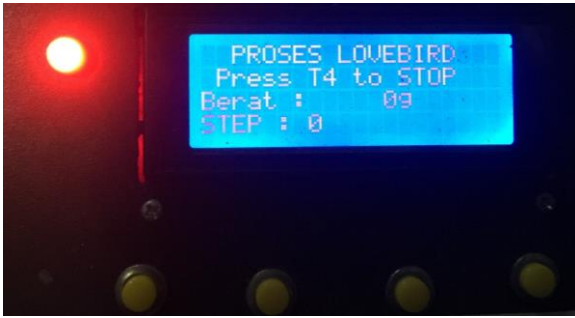
Gambar 5.7 Lampu Indikator Jika Merah Alat Baru Berjalan Meproses Perintah
