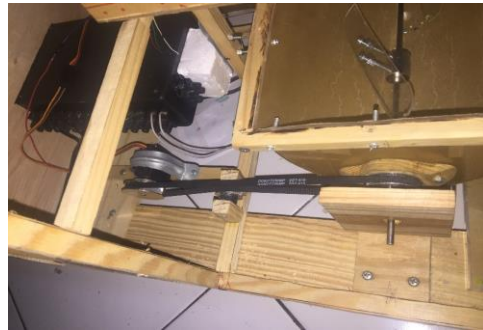
Gambar 5.5 Motor Servo Yang Menuangkan Bahan Dari Mesin Mixing ke Penampung.
