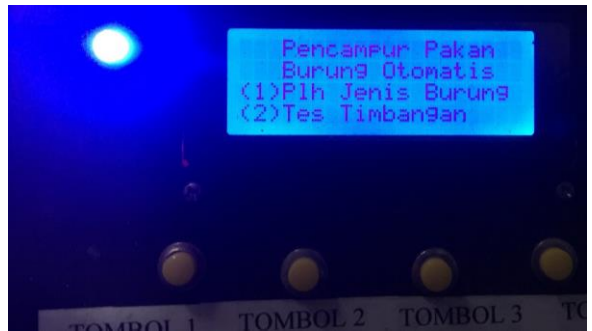
Gambar 5.6 Lampu Indikator Warna Biru Jika Alat Siap Digunakan.
