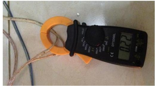
**Gambar 4.4** hasil pengukuran arus pada rangkaian lampu tanpa kendali otomatis
