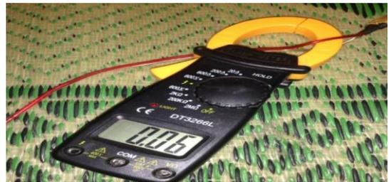
**Gambar 4.5** Hasil Pengukuran Arus Pada Rangkaian Kipas Pendingngin Tanpa Kendali otomatis
