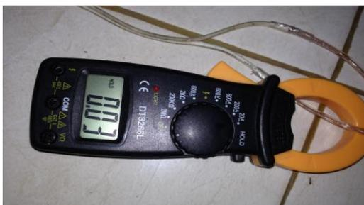
**Gambar 4.7** Pengukuran Arus Pada Rangkaian Kipas Dengan Menggunakan Kendali otomatis
