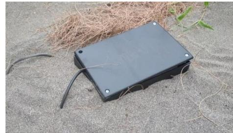
Gambar 9: Sensor DS18B20 *waterproof* di permukaan pasir
