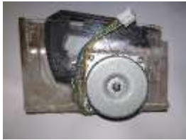
Gambar 15: Gear Beserta Generator Yang Sudah Terpasang
