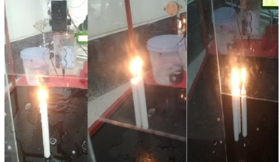
Gambar 5.9 Pengujian Alat dengan Lilin Sebagai Pemicu Kebakaran
