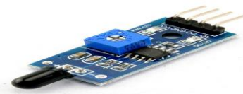
Gambar 2.3 Flame Sensor (Sumber: Duniapembangkitlistrik.com)
