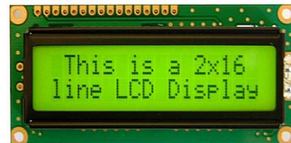
Gambar 2.7 Bentuk Fisik LCD 16x2 (Sumber: Leselektronika.com)
