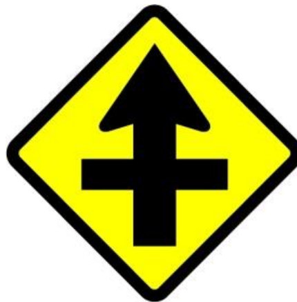
Gambar 12 Rambu Peringatan Simpang Empat Prioritas
