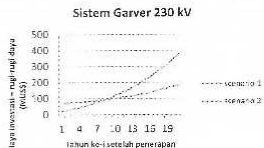
Gambar 11. Perbandingan biaya investasi + rugi-rugi daya antara skenario 1 dan skenario 2 sistem Garver 230 kV
