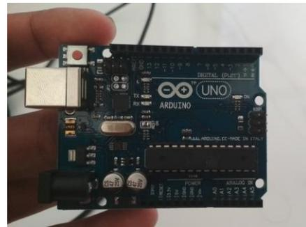
Gambar 4. Modul Arduino uno
