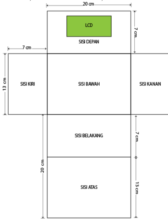
Gambar 3 Desain box elektronik
