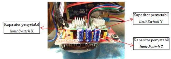
Gambar 6. 5 Hasil rangkaian elektronik penyetabil Limit Switch
