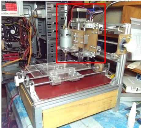
Gambar 6. 8 Hasil pembuatan mekanik sumbu Z
