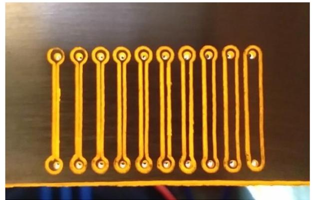
Gambar 6. 14 Hasil pembuatan jalur dan lobang PCB setelah di amplas
