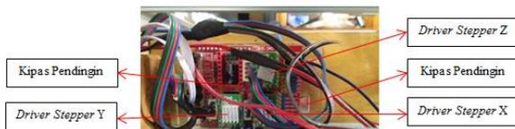
Gambar 6. 4 Hasil rangkaian elektronik CNC Shield, Motor Driver A4988 dan Arduino
