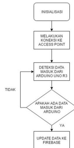
Gambar 3. Flowchart Pada Node MCU
