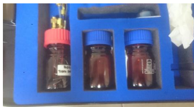
Gambar. 3 Botol Minyak Transformator
