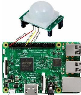
Gambar 3.2 : Rangkaian sensor PIR dengan Rasp Pi 3
