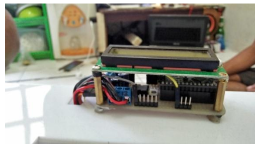
Gambar 18 Rangkaian Mikrokontroler dan LCD Monitor
