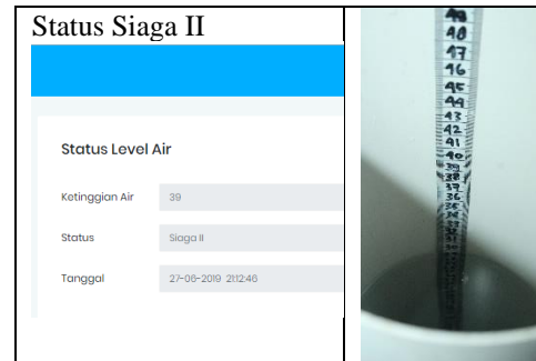
Gambar 14 Hasil Pengujian menggunakan pipa paralon dengan status Siaga II
