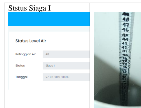
Gambar 15 Hasil Pengujian menggunakan pipa paralon dengan ststus Siaga I
