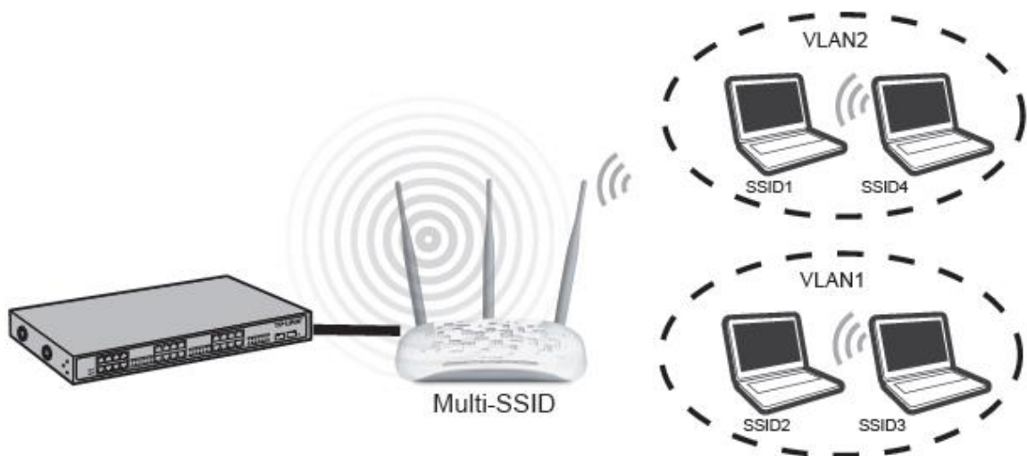
Gambar 6.1 Pemasangan AP dengan model Multi-SSID
