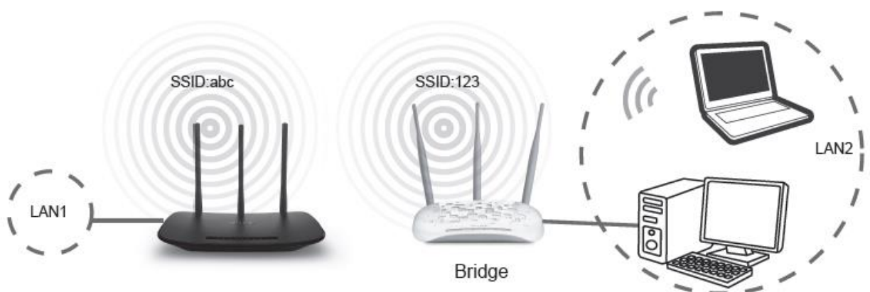
Gambar 4.1 Topologi Pemasangan AP dengan model Bridge
