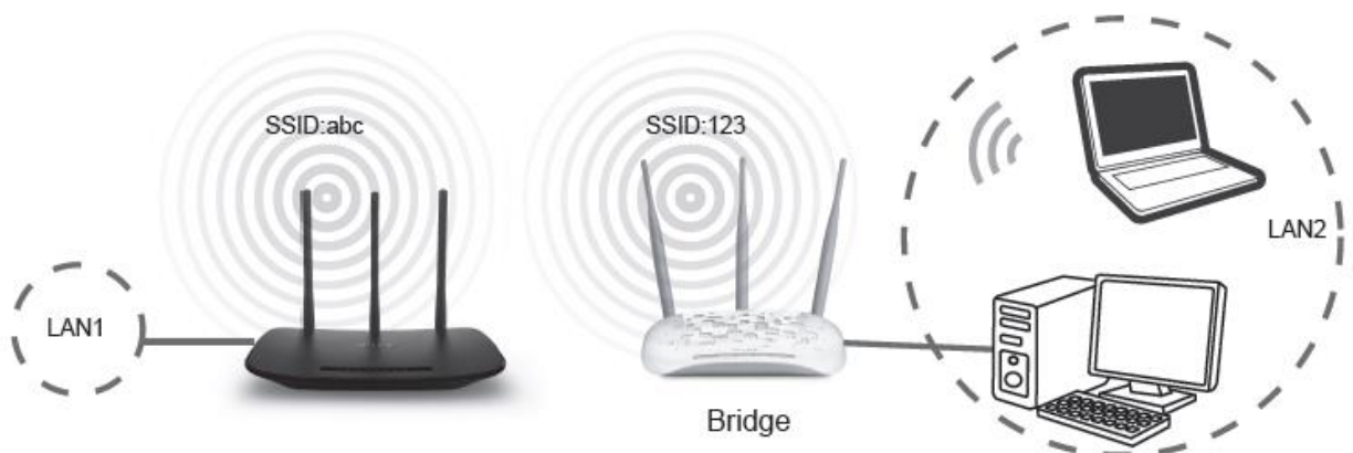
Gambar 4.1 Topologi Pemasangan AP dengan model Bridge
