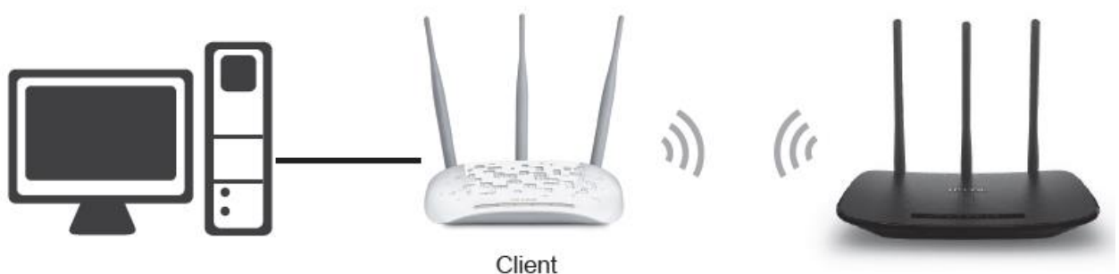
Gambar 5.1 Pemasangan topologi AP dengan model client
